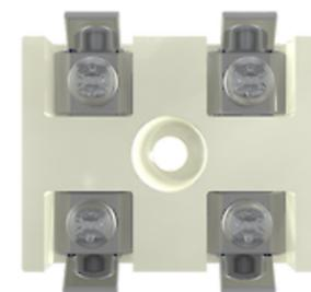
Двухполюсные соединительные зажимы АК обеспечивают безопасное, надежное и термостойкое соединение нагревательных элементов Elstein с электрической сетью; они предназначены для кабелей с максимальным сечением провода 2,5 мм<sup>2</sup> и крепятся к монтажному профилю места для проводки с помощью прилагаемого винта.
